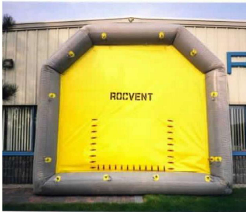
Slika 3-2. Privremena vjetrena pregrada na komprimirani zrak (Klanfar, 2018.)
