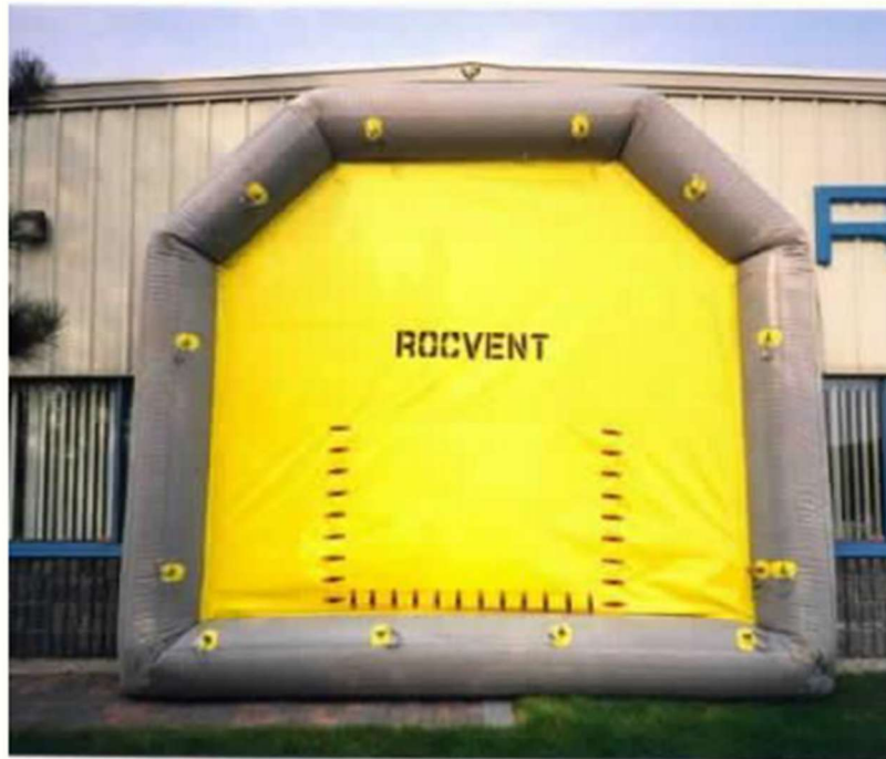
Slika 3-2. Privremena vjetrena pregrada na komprimirani zrak (Klanfar, 2018.)
