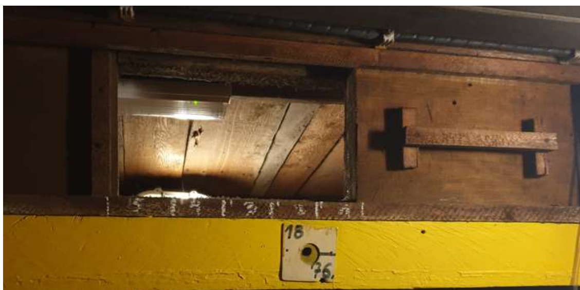
Slika 4-6. Regulacijski otvor na vjetrenim vratima
