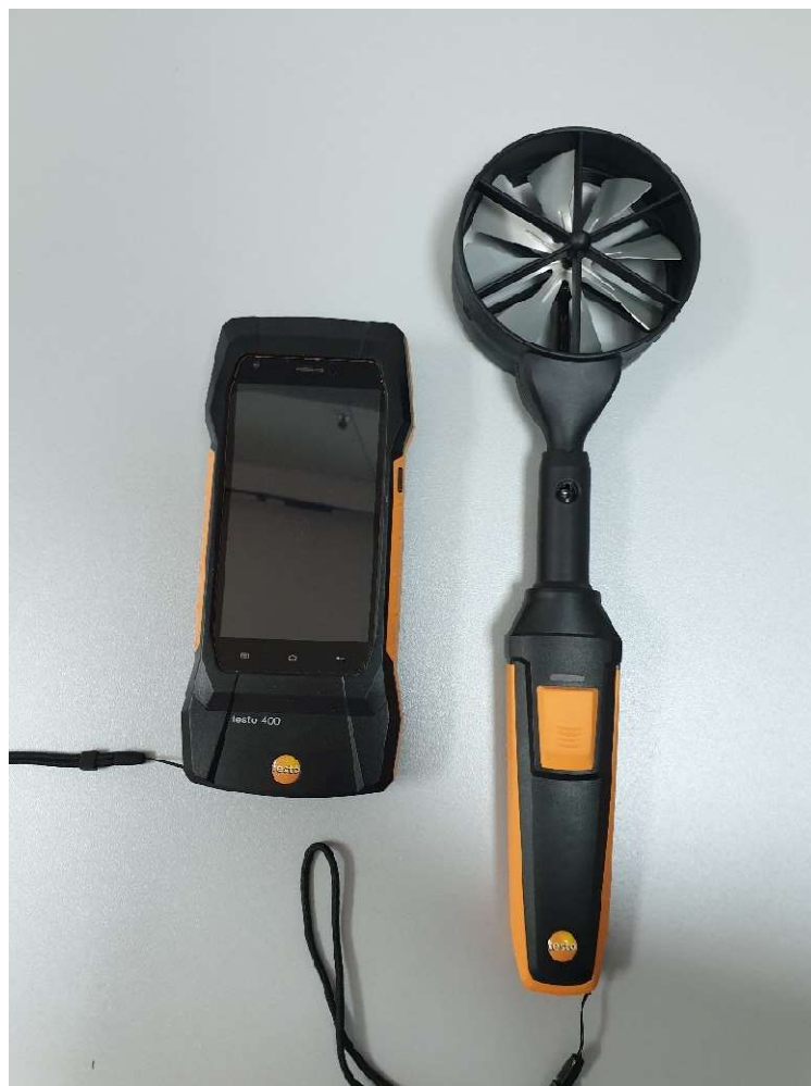
Slika 4-5. Multifunkcijski uređaj za mjerenje Testo 400 sa krilnom sondom
