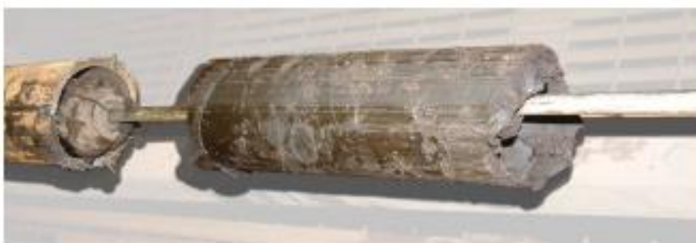
Slika 4-1. Parafin nakupljen oko klipnih šipki unutar tubinga (Bellarby, 2009)
