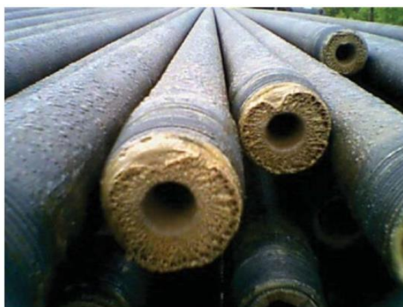
Slika 2-3. Primjer smanjenja protočne površine cijevi uzrokovane izdvajanjem barijevog sulfata (Bellarby, 2009)
