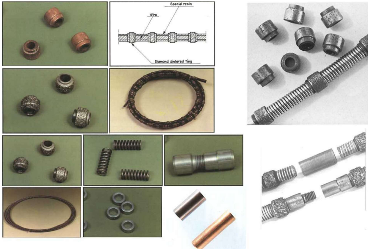
Slika 2-3. Osnovni dijelovi koji čine dijamantnu žicu Dunda i Kujundžić ( 2003.).
