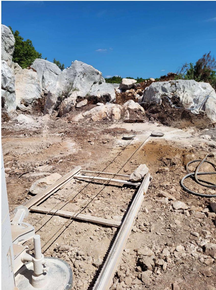
Slika 5-1. Dijamantna pila pri piljenju horizontalnog reza na EP BAG.
