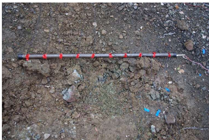
Slika 4-2. Postav mjerenja brzine detonacije u čeličnim cijevima.
