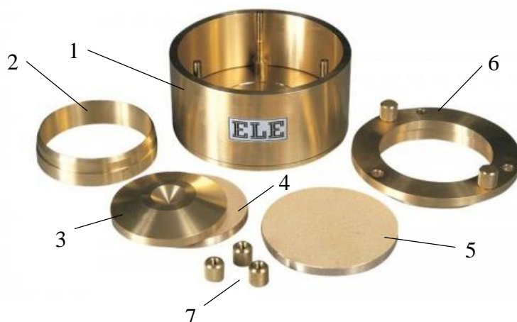
Slika 4-3. Edometarska ćelija za uzorak (izvor: https://www.ele.com/ )
