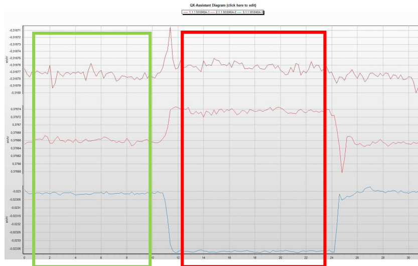
Slika 6-3. Prikaz razlike signala koje šalje senzor bez i sa opterećenjem pri opterećenju osi X sa utegom 0,5kg
