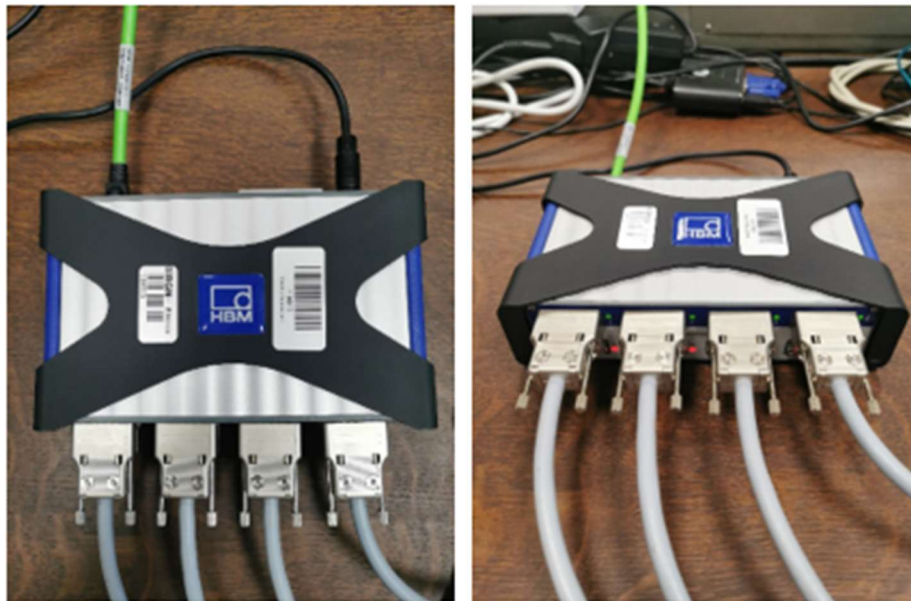
Slika 6-1. Uređaj za prikupljanje podataka HBM QuantumX MX840A (dva pogleda)
