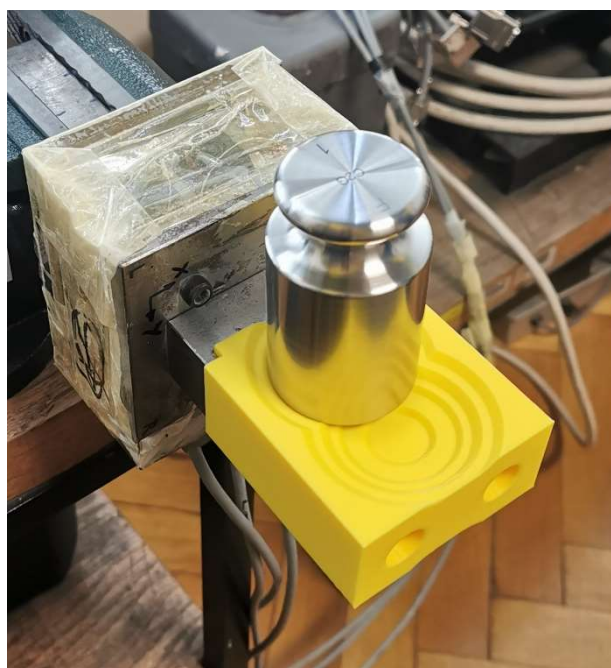
Slika 5-18. Opterećenje EC dodatka utegom neke mase
