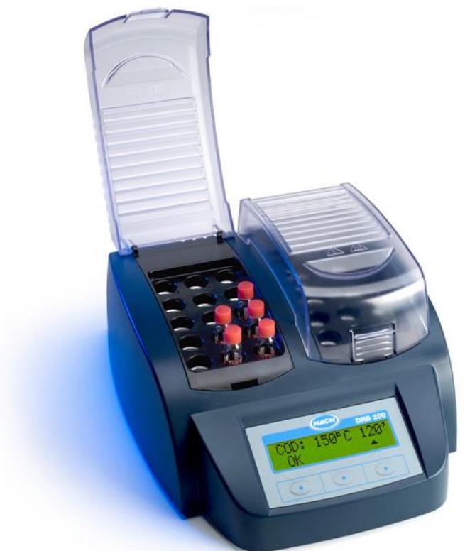
Slika 3-4. Hachov reaktor za određivanje KPK
