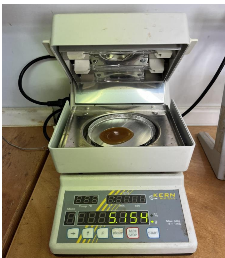
Slika 7-9. Određivanje MLSS-a pomoću KERN analitičke vaga
