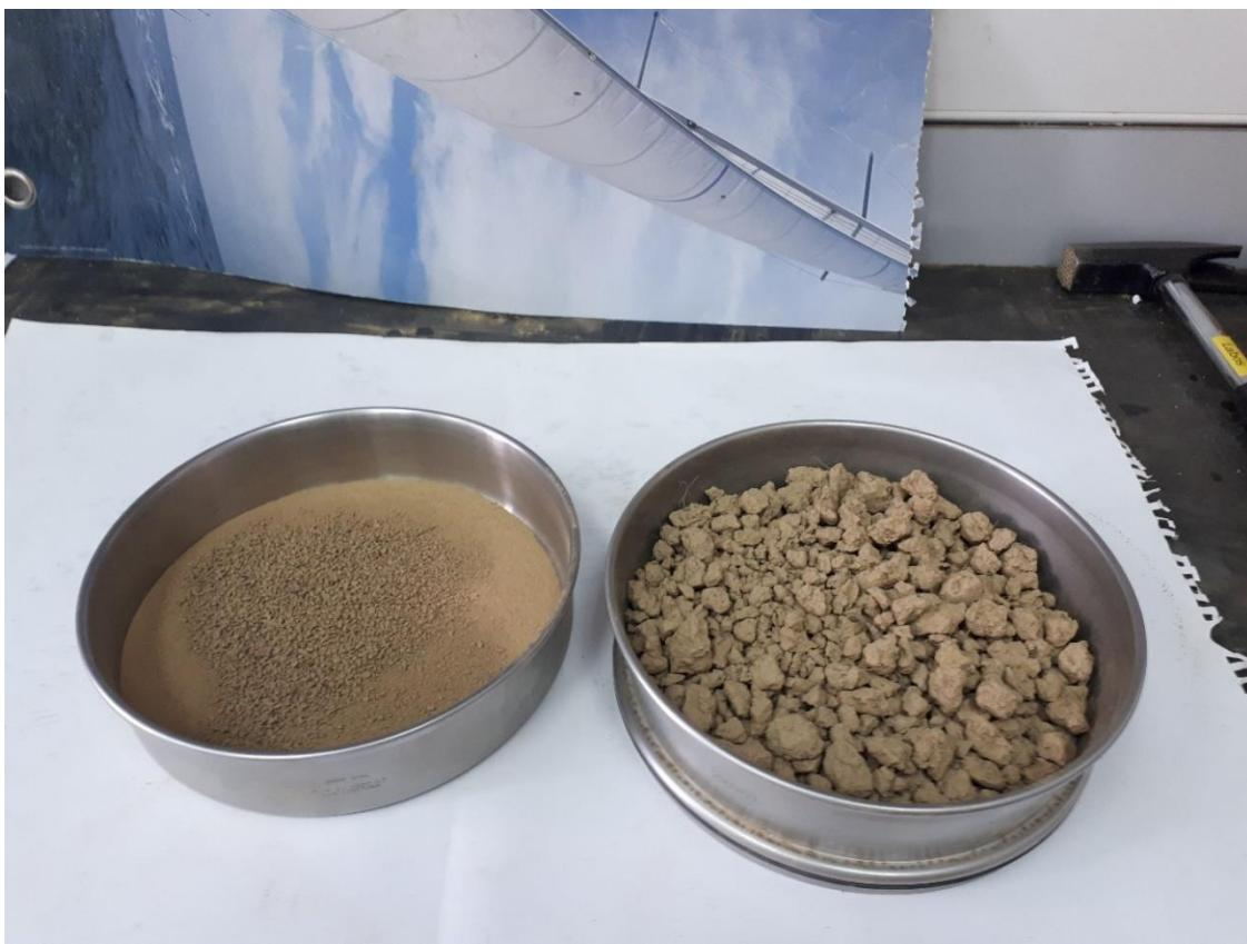
**Slika 3-3.** Uzorak u situ za prosijavanje na frakciju  $< 2 \text{ mm}$
