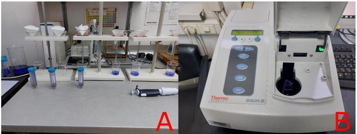
**Slika 3-9.** Određivanje kapaciteta kationske zamjene (CEC), A) Filtriranje uzorka, B) snimanje uzorka na spektrofotometru
