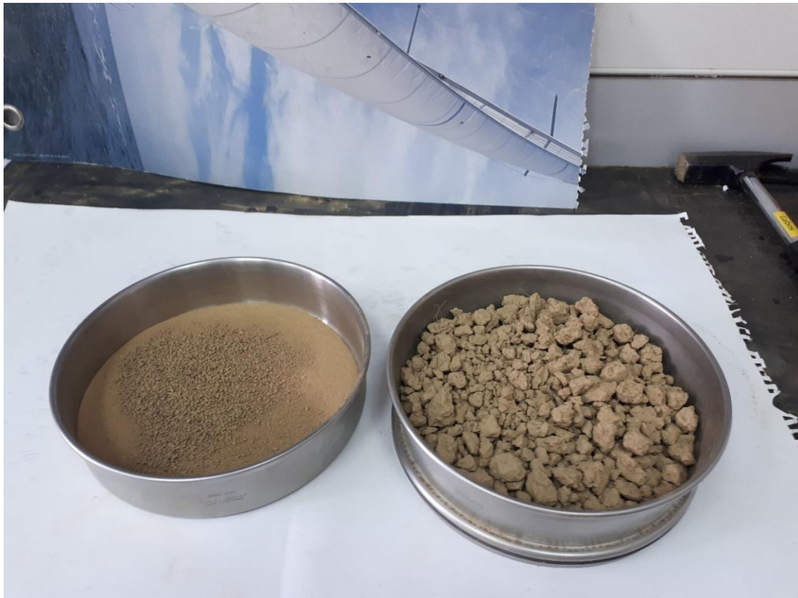
Slika 3-3. Uzorak u situ za prosijavanje na frakciju <math>< 2\text{ mm}</math>
