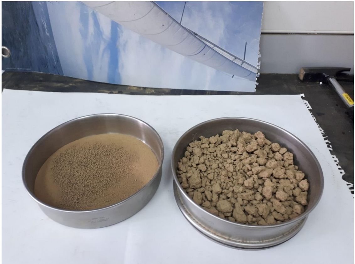
Slika 3-3. Uzorak u situ za prosijavanje na frakciju < 2 mm
