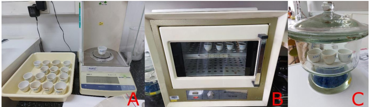
Slika 3-7. Određivanje udjela vlage u uzorcima, A) Vaganje uzoraka, B) Sušenje uzoraka, C) Uzorci u desikatoru spremni za ponovno vaganje
