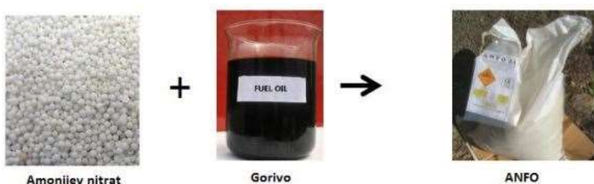
Slika 3-1. Shematski prikaz proizvodnje ANFO eksploziva (Bohanek 2016)
