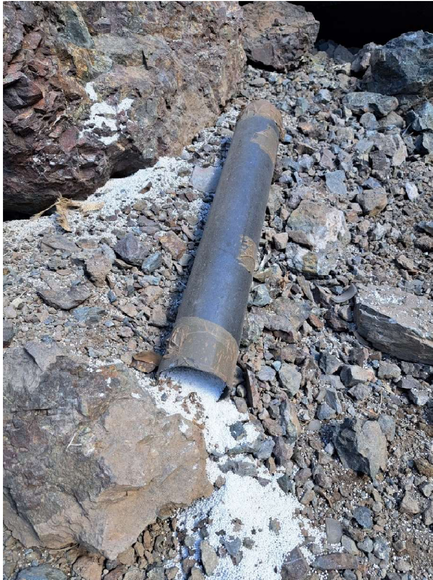
Slika 4-14. Ispitni uzorak kod kojega nije došlo do prijenosa detonacije
