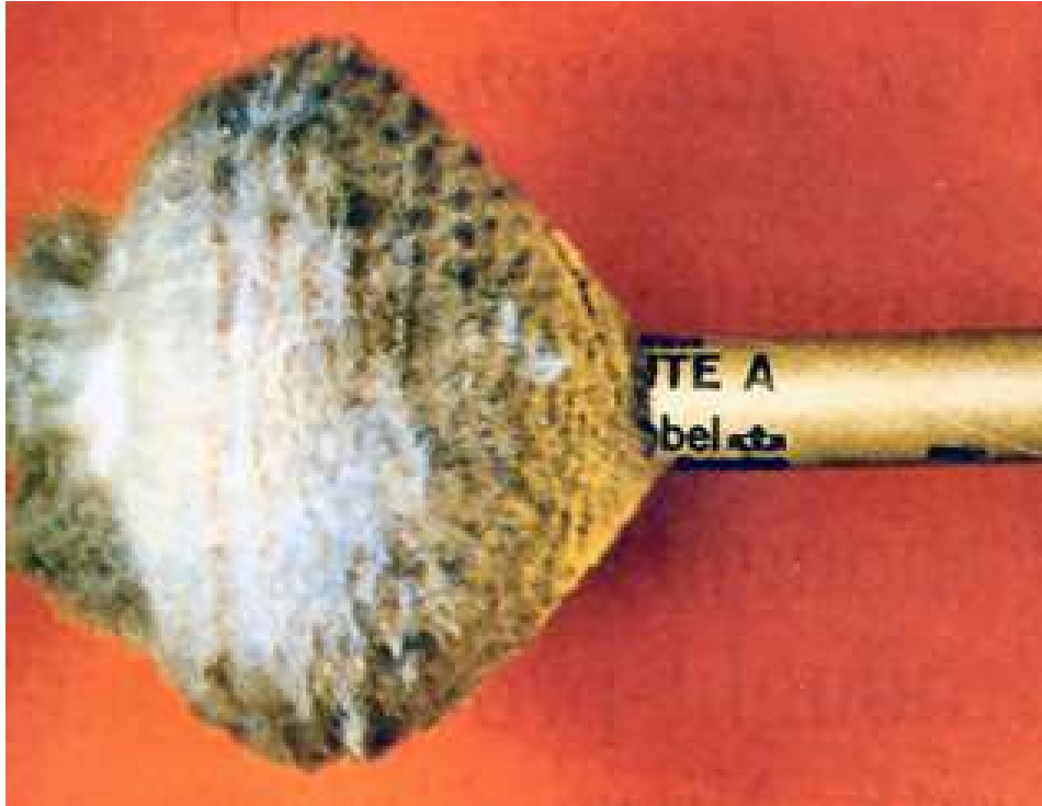
Slika 2-4. Patrona eksploziva pri detonaciji (Škrlec 2015)
