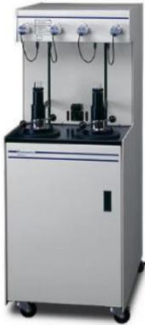
Slika 2-4. Automatizirani uređaj utiskivanja žive (McPhee et al., 2015)
