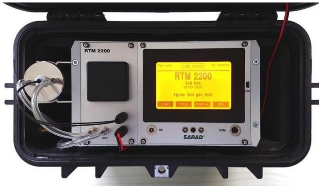
Slika 4.2-2. Uređaj za mjerenje koncentracije radona. (SARAD, 2020)
