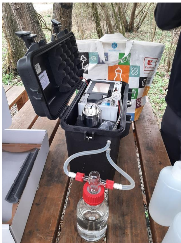
Slika 4.4-2. Mjerenje koncentracije radona u vodi.
