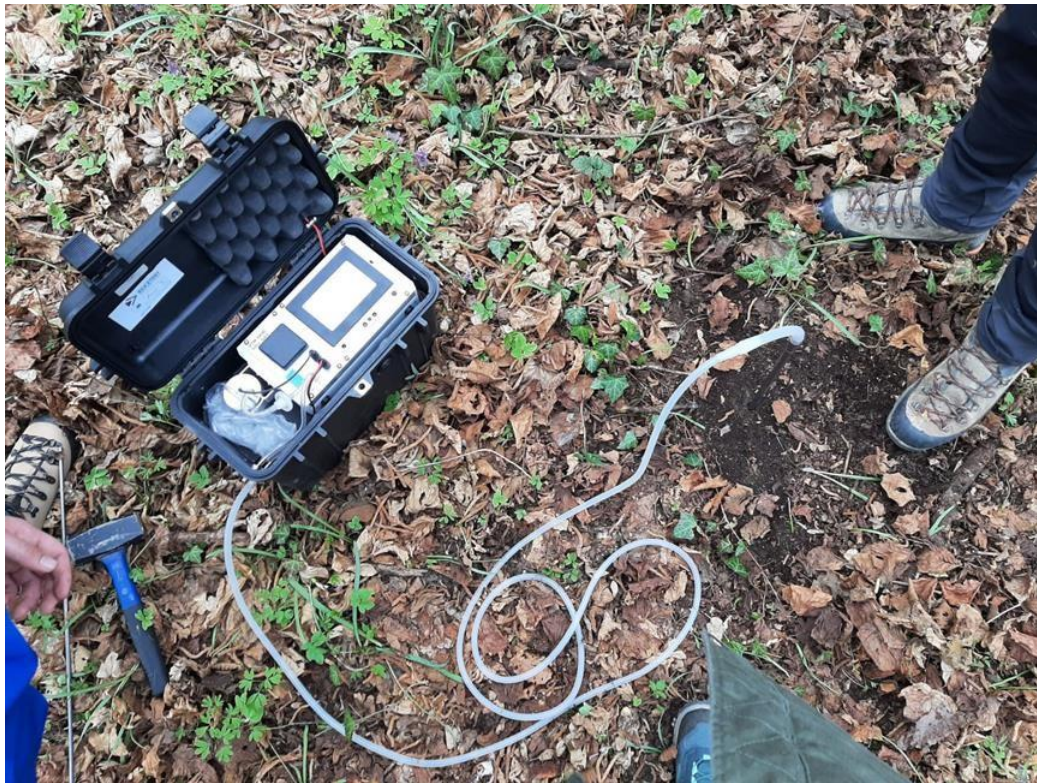
Slika 4.3-1. Mjerenje koncentracije radona u zraku tla.
