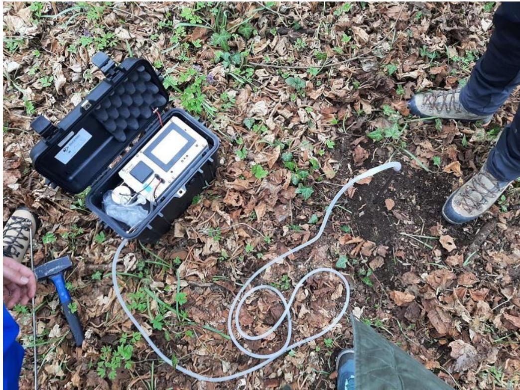
**Slika 4.3-1.** Mjerenje koncentracije radona u zraku tla.
