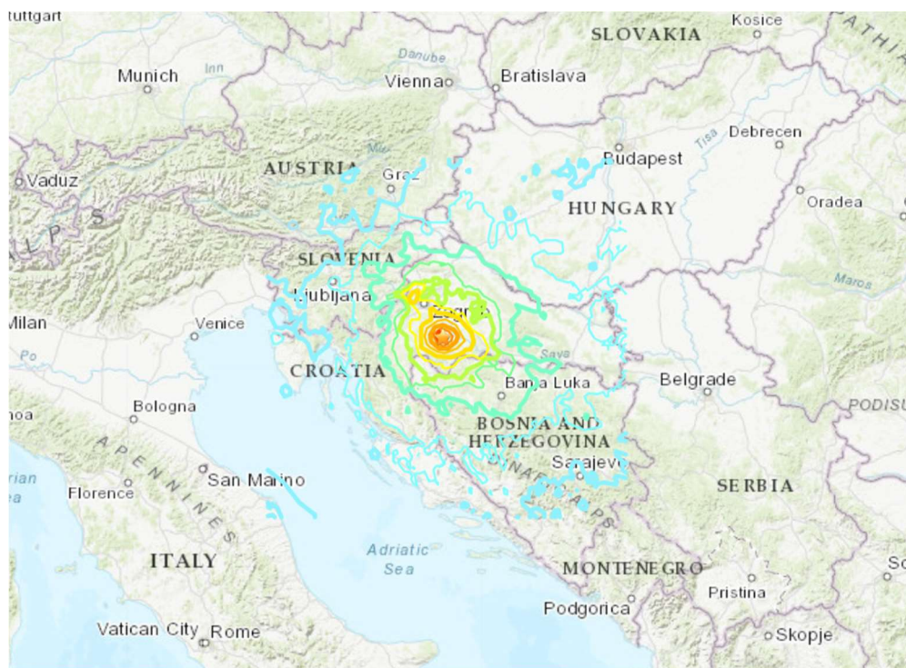
Slika 3-1. Karta podrhtavanja površine tla za vrijeme glavnog potresa u Petrinji izraženo vrijednostima horizontalnih vršnih ubrzanja tla u postocima gravitacijskog ubrzanja (Earthquake, 2022)
