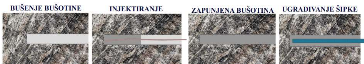
Slika 2-6. Izvedba štapnog sidra (Ivšić, 2012)
