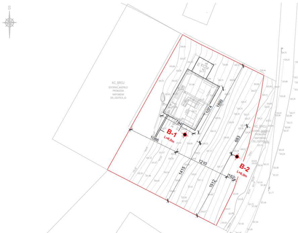
Slika 4-4. Pozicije istražnih bušotina u tlocrtu (Martomis projekt, 2022)
