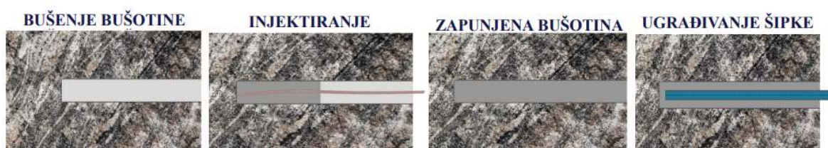
Slika 2-6. Izvedba štapnog sidra (Ivšić, 2012)
