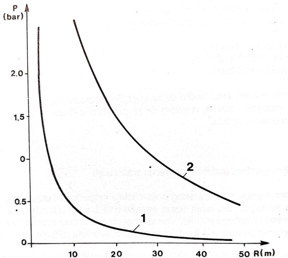
Slika 5-3. Promjene udarnog tlaka u ovisnosti o udaljenosti (Krsnik, 1989)
