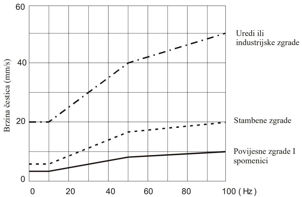
**Slika 7-1.** Dijagram granica brzina čestica za određene tipove konstrukcija u funkciji frekvencije prema DIN 4150 (Stanković, 2011)
