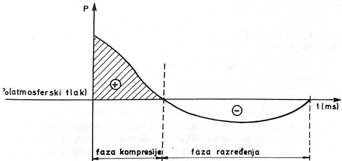
Slika 5-2. Idealni zračni udarni val (Krsnik, 1989)
