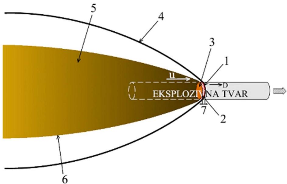
Slika 3-3. Shematski prikaz detonacije u patroni eksploziva (Sućeska, 2001)
