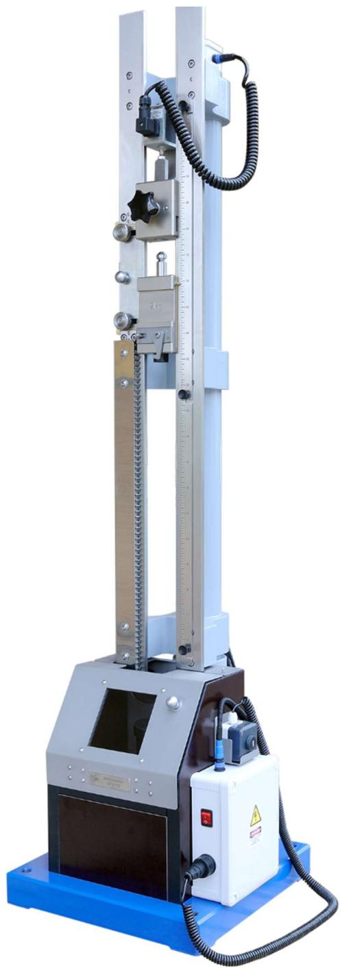
Slika 3-7. Uredaj za određivanje osjetljivosti eksploziva na udar (Mueller instruments, n. d.)
