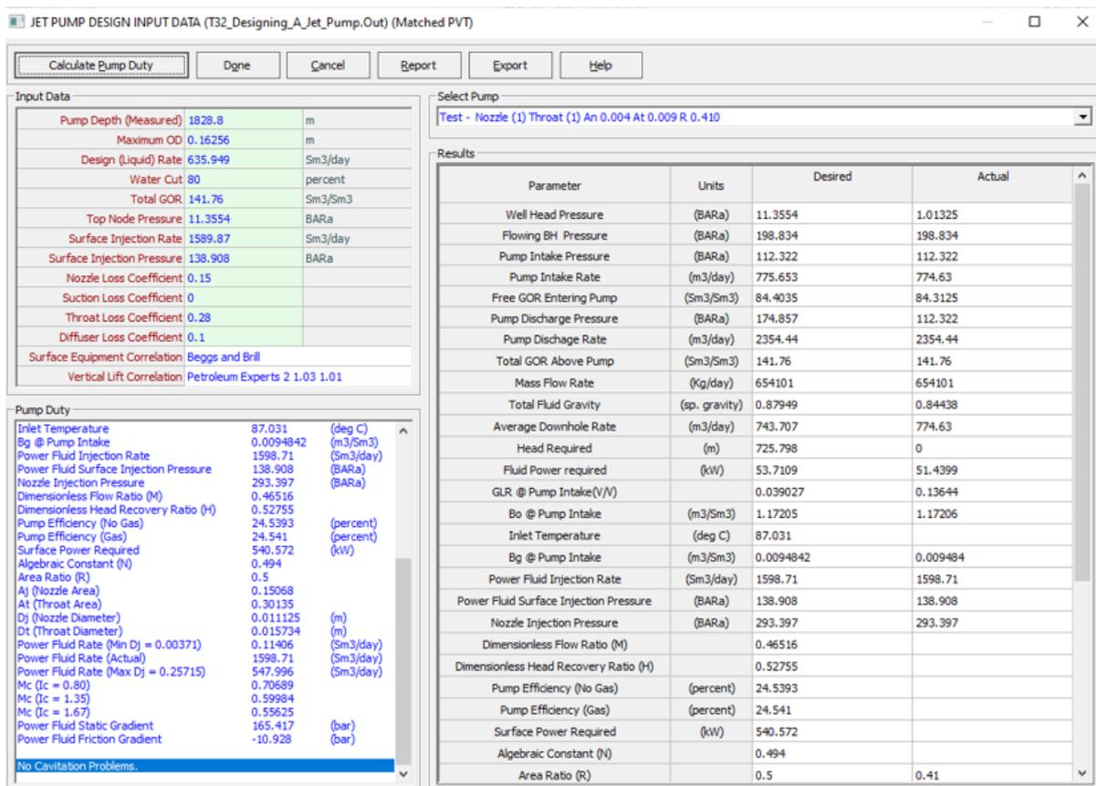
Slika 3.10. Prozor za unos podataka potrebnih za dimenzioniranje mlazne crpke
