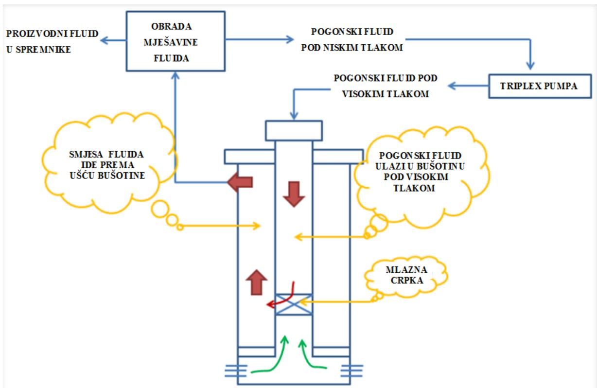
Slika 2-1. Shematski prikaz proizvodnje u sustavu s mlaznom crpkom (Fetoui, 2017)
