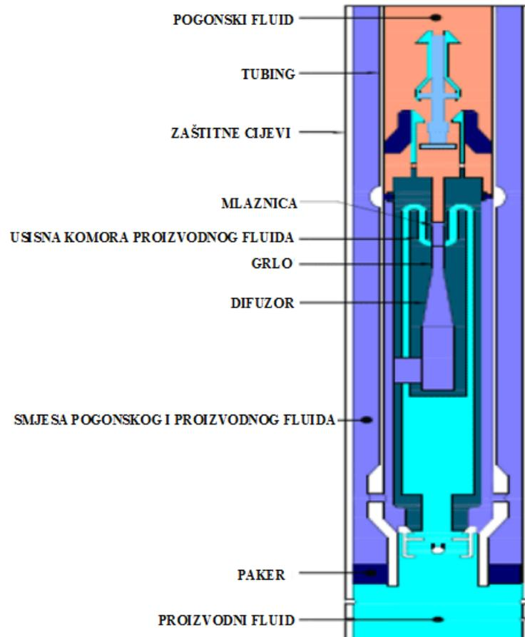
**Slika 2-2.** Shematski prikaz mlazne crpke (Prime Tech, 2019)
