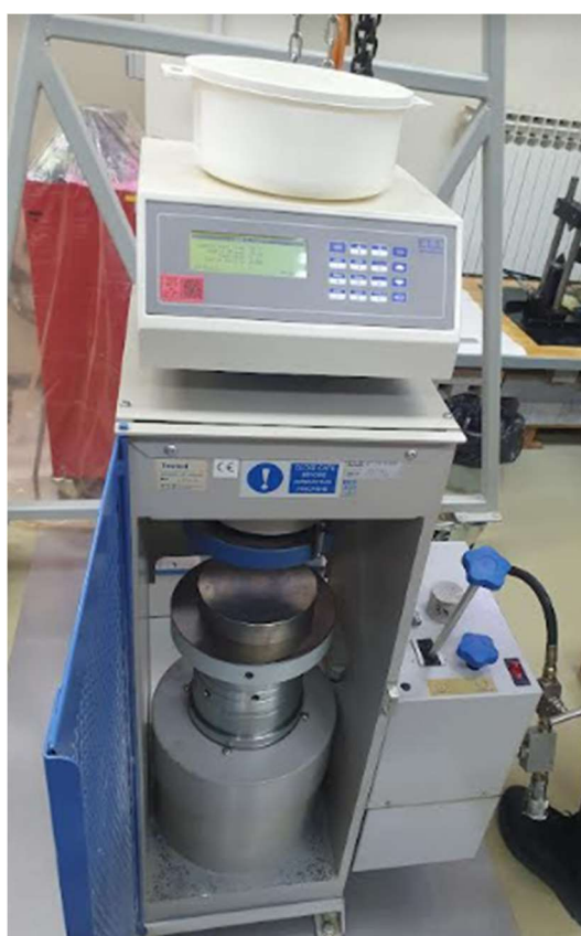
Slika 3-2. Prikaz uređaja za ispitivanje jednoosne tlačne čvrstoće
