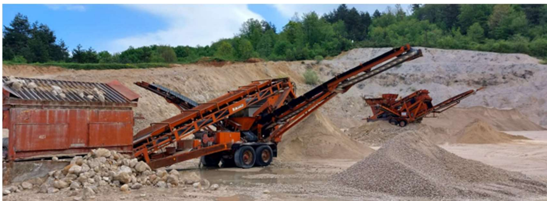
Slika 4-5. Pokretno postrojenje za klasiranja stijenskog materijala (Galić i dr., 2023)
