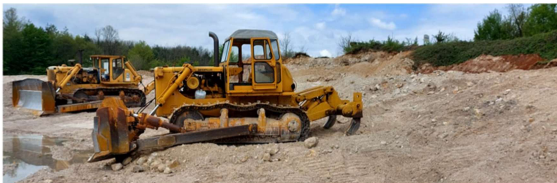
Slika 4-1. Buldozer s riperom od 2 zuba (Galić i dr., 2023)
