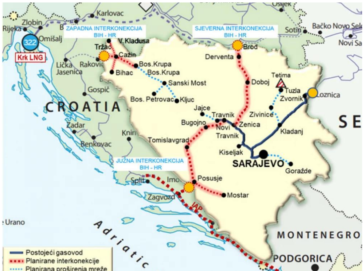
Slika 4-3. Planirana sjeverna i južna interkonekcija između Hrvatske i Bosne i Hercegovine (Bloomberg Adria, 2023)
