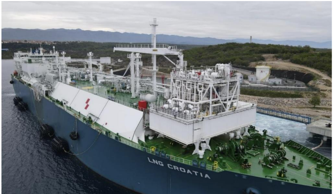
Slika 2-1. Postojeći modul za uplinjavanje na FSRU brodu LNG Croatia (LNG Hrvatska, 2023)
