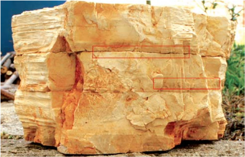
Sl. 7 Kontakt karbonatni muljnjak-kalkarenit: oštri (gore) i blagi (dolje)
