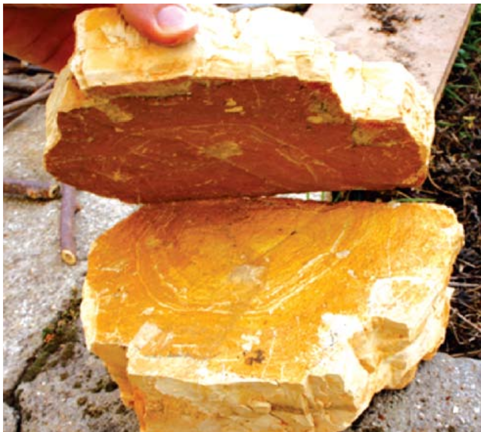
Sl. 8 Pojave zemljanog (glinovitog) materijala unutar "zatvorenih slojnica" olakšavaju razdvajanje
