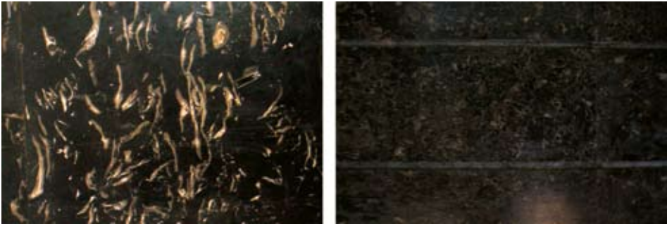
Sl. 5. Crni litiotis vapnenac s ostacima školjke Lithiotis problematica (lijevo) i brački vapnenac rasantica (desno) ugrađen na unutrašnju vertikalnu površinu
