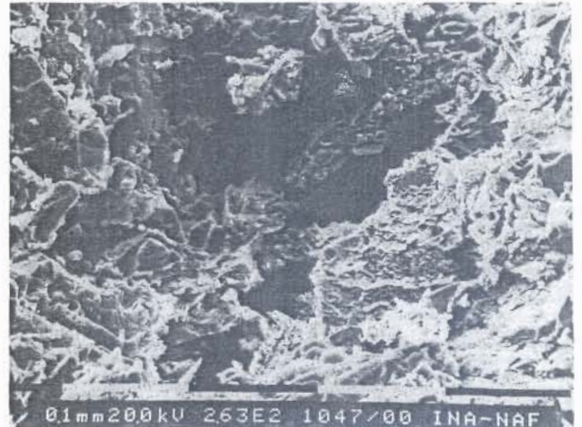
Sl. 7. Trošni varijetet trahandezita; vrlo izražene mikropukotine i mikroblokovi s tragovima minerala glina (snimak elektronskim mikroskopom)
