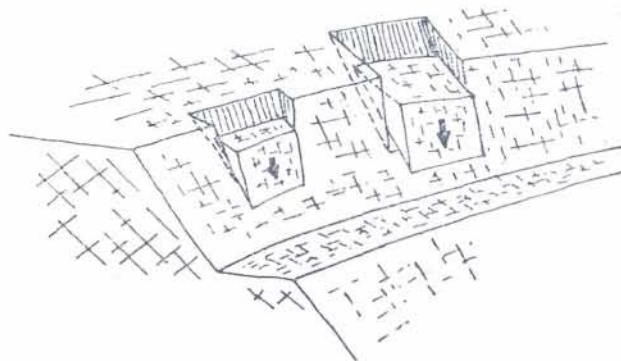
Sl. 2 Tip klinova kada slojevi padaju u smjeru kosine
