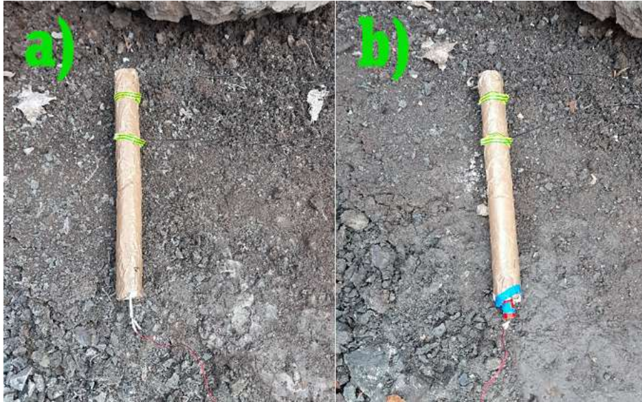
Slika 4-6. Postav mjerenja za promjer 50 mm a) iniciranje električnim detonatorom b) iniciranje električnim detonatorom s pojačnikom.
