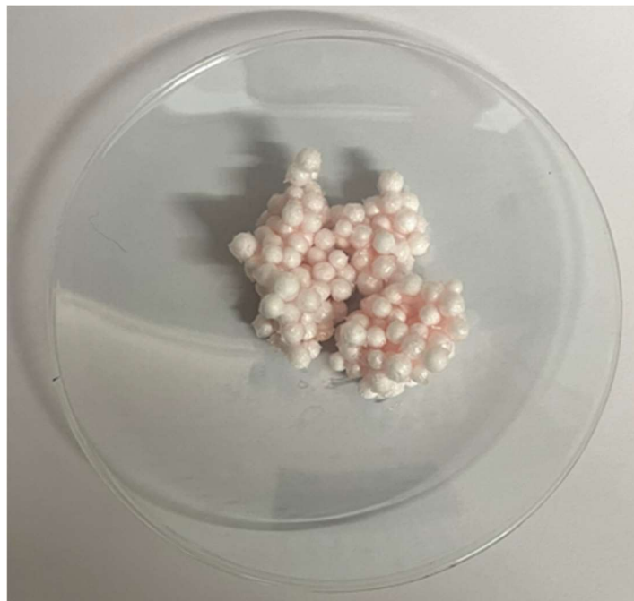
Slika 5-2 Uzorak eksploziva s granulacijom EPS 2-4 mm
