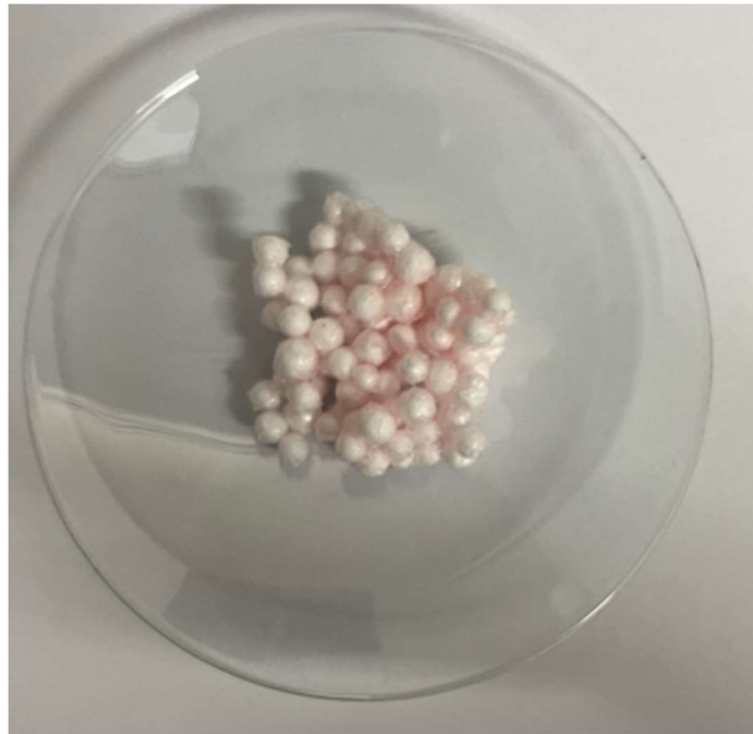
Slika 5-1 Uzorak eksploziva s granulacijom EPS +4 mm
