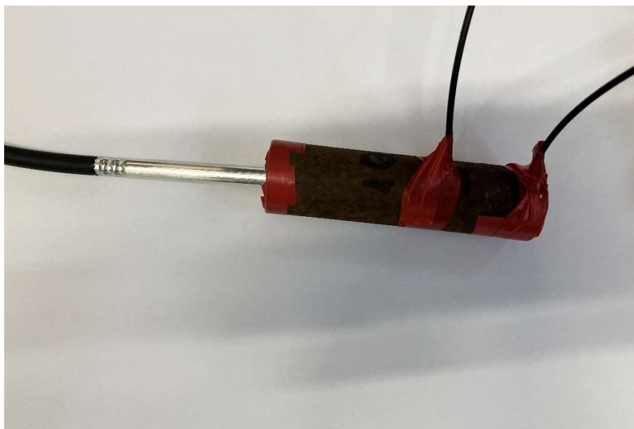
Slika 5-5 Postav mjerenja brzine detonacije
