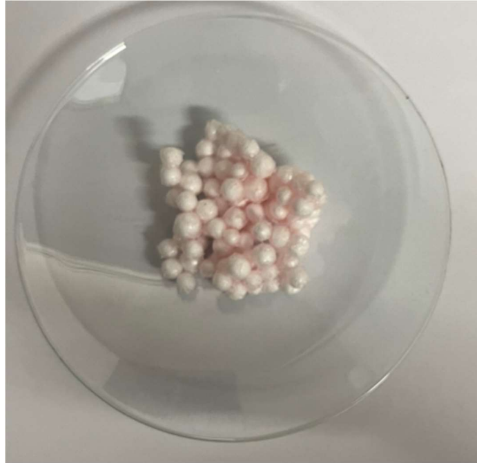
Slika 5-1 Uzorak eksploziva s granulacijom EPS +4 mm
