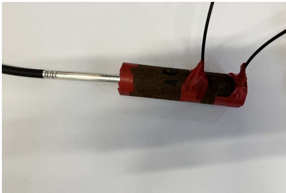
Slika 5-5 Postav mjerenja brzine detonacije
