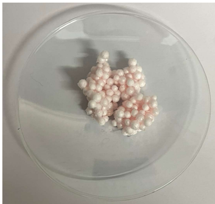
Slika 5-2 Uzorak eksploziva s granulacijom EPS 2-4 mm
