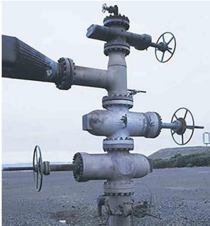
Slika 5-2. Bušotinska glava geotermalne bušotine (Schlumberger, 2020)
