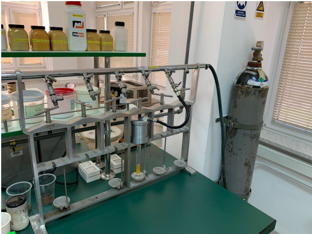
Slika 2-3. API filter preša
