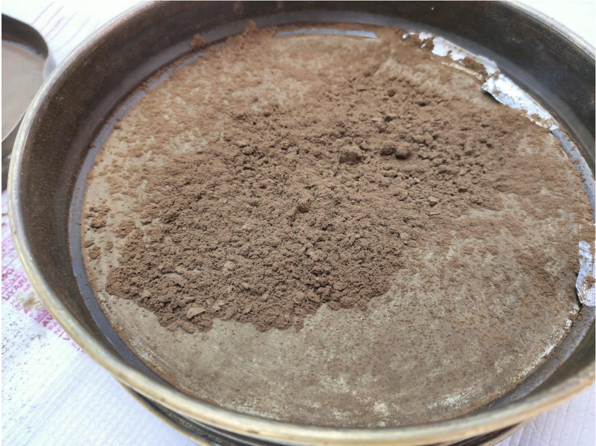
Slika 4-7. Prah komine masline veličine čestica od 0,1 mm do 0,16 mm
