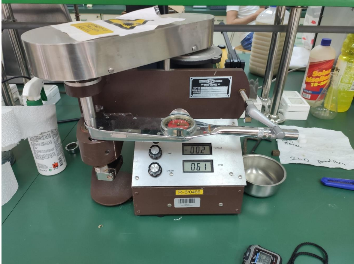
Slika 4-3. Uređaj za određivanje podmazujućih svojstava isplake
