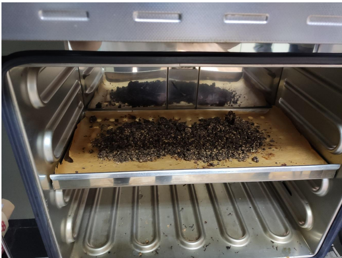
Slika 4-4. Sušionik u kojem se dehidrirala komina masline
