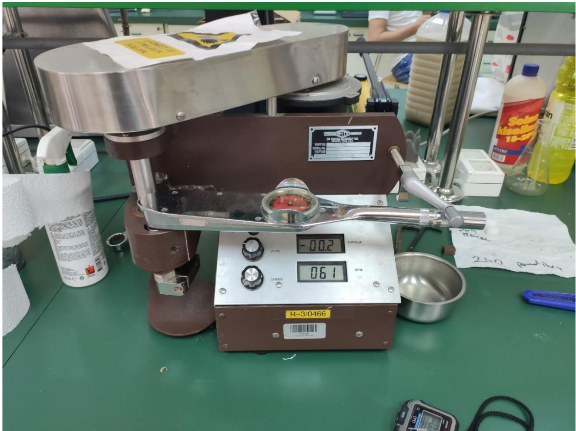
Slika 4-3. Uređaj za određivanje podmazujućih svojstava isplake
