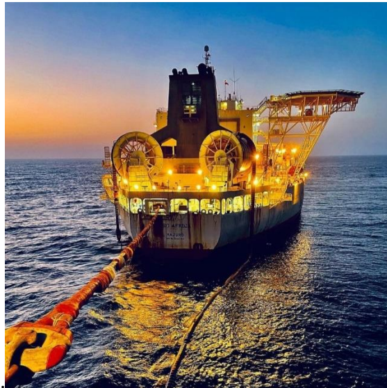
Slika 2-5. Prikaz fiksne veze između tankera i FPSO postrojenja (PES – Power and Energy Solutions, 2021)
