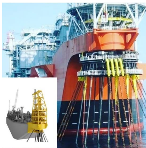
Slika 3-8. Vanjski sustav priveza kupole (T2Alloys, 2020)
