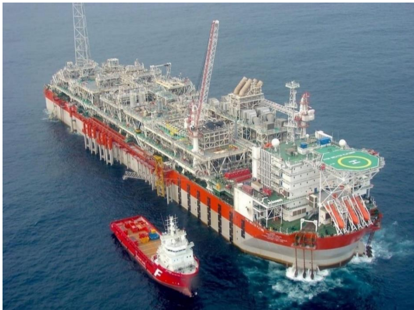
Slika 2-4. Odobalno postrojenje za proizvodnju, skladištenje i iskrcaj nafte (Oilgascourse, 2021)
