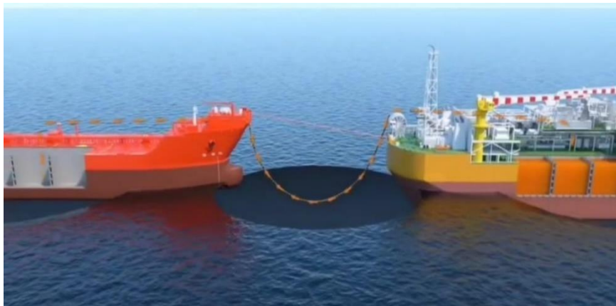
Slika 2-6. Sustav istovara nafte fleksibilnim crijevom na površini mora (Youtube, 2018)
