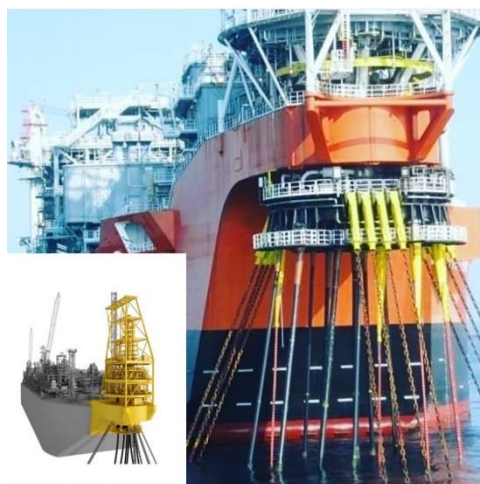
Slika 3-8. Vanjski sustav priveza kupole (T2Alloys, 2020)
