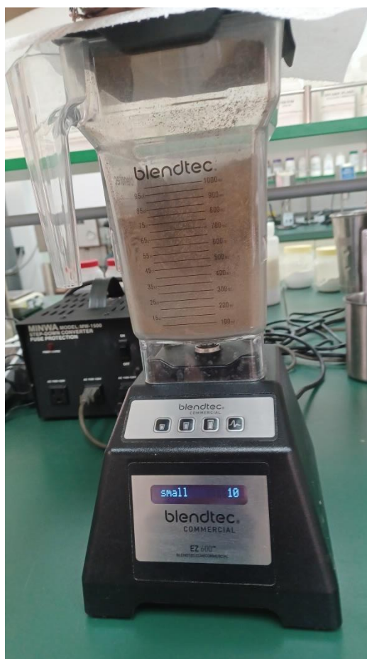
Slika 3-1. Usitnjavanje komine maslina pomoću blendera
