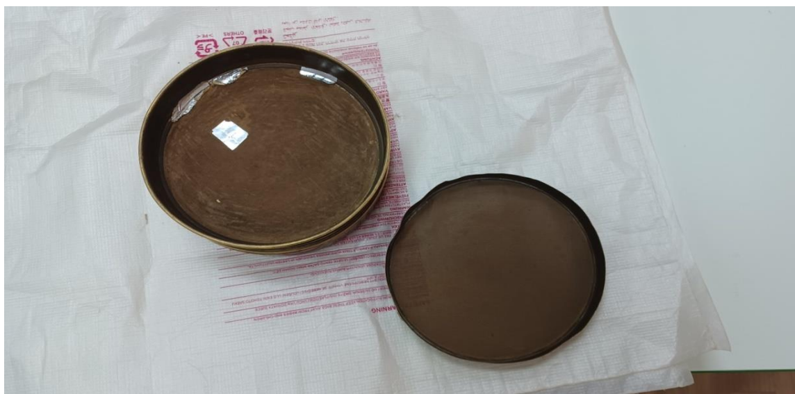
Slika 3-2. Sita za prosijavanje komine maslina
