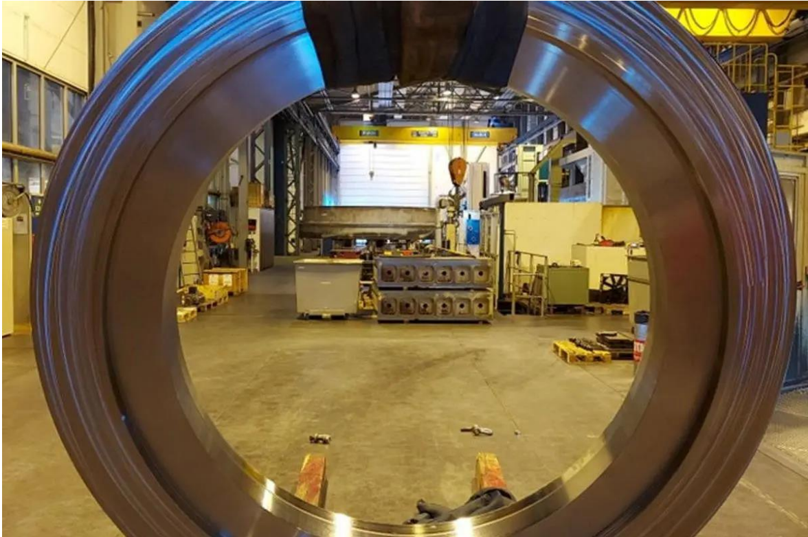
Slika 4-6. Najveći objekt izrađen 3D printanjem u naftnoj industriji (Equinor, n.d.f)
