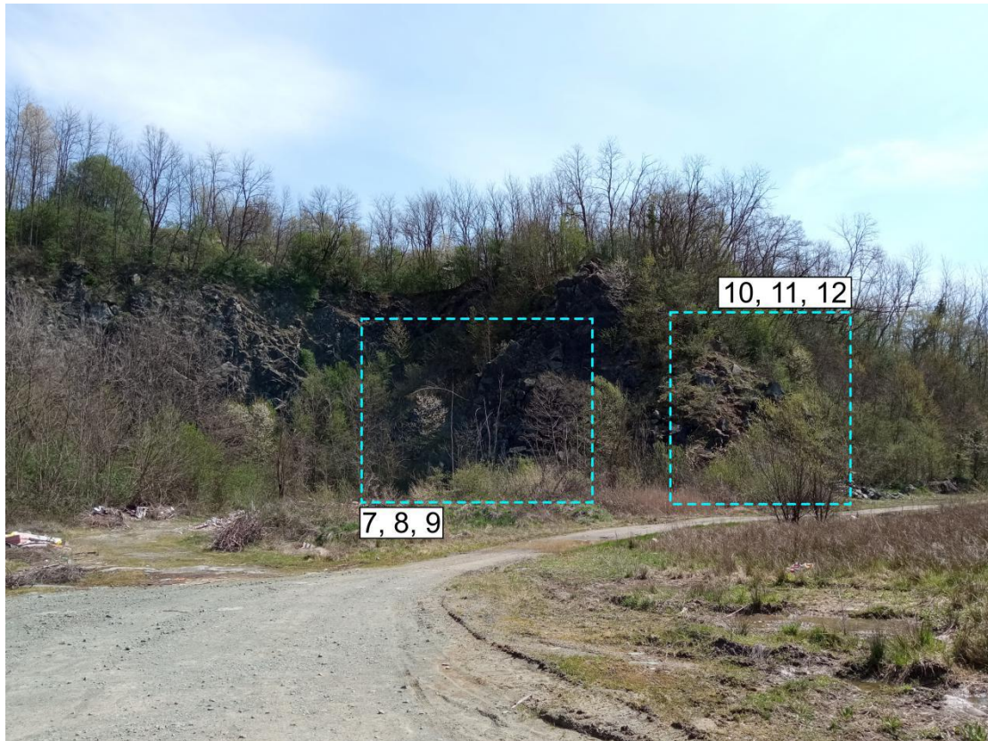
Slika 5.2: Istočni dio kamenoloma. U plavim pravokutnicima su istaknuta dva područja uzorkovanja. Uzorci 7, 8 i 9 su iz sjevernijeg dijela, dok su uzorci 10, 11 i 12 iz južnijeg dijela.
