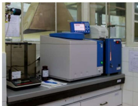
Slika 4-3. Kalorimetar (IKA-C2000, Njemačka)
