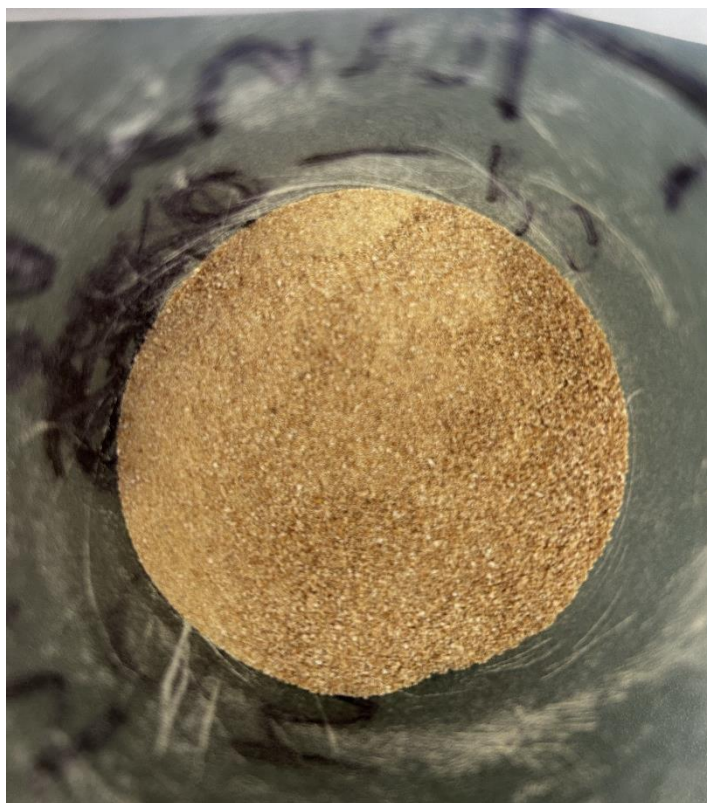
Slika 3- 2. Mješavina A čestica praha kore mandarine u rasponu promjera od 0,1 do 0,5 mm
