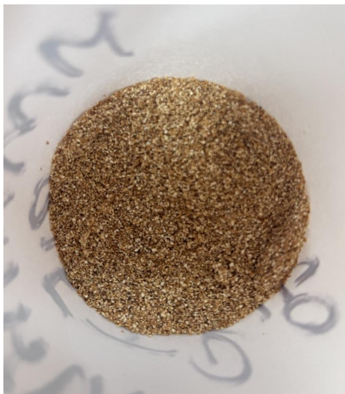
Slika 3- 3. Mješavina B čestica praha kore mandarine u rasponu promjera od 0,5 do 0,8 mm
