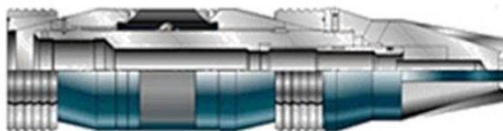
Slika 6-2. Cementacijski paker (Arthur i Hochheiser, 2011)
