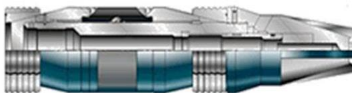
Slika 6-2. Cementacijski paker (Arthur i Hochheiser, 2011)
