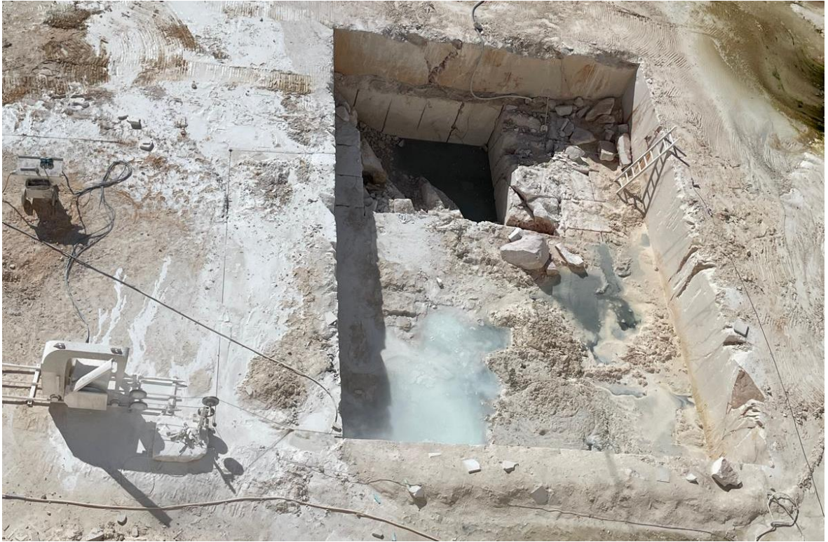
Slika 4-10. Piljenje bočnog reza dijamantnom žičnom pilom
