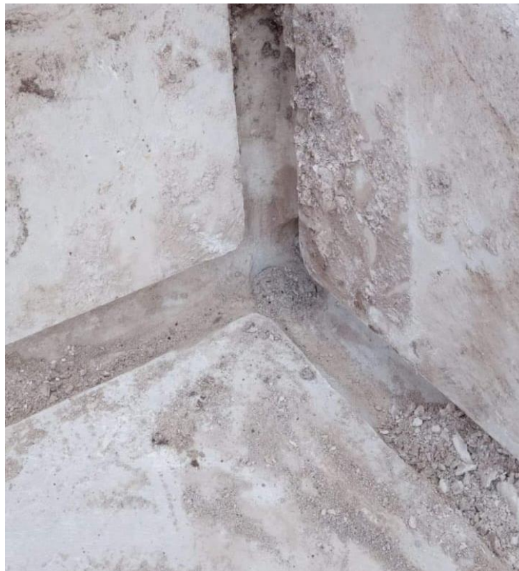
Slika 2-10. Vertikalne i horizontalne bušotine spojene u jednoj točki (Instagram. Fotografija korisnika Seçkin Satılar, 2024.). https://www.instagram.com/scknstrs/
