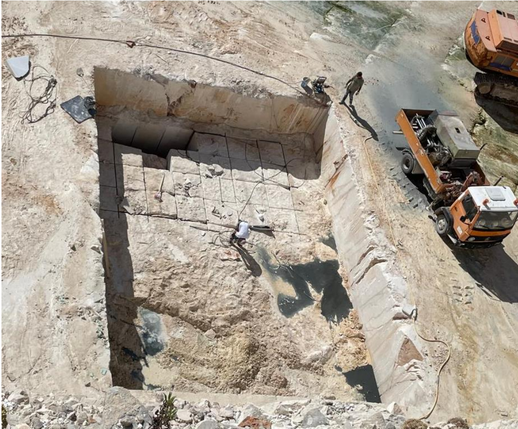
Slika 4-9. Izrađena mreža rezova za napredovanje na nižu etažu
