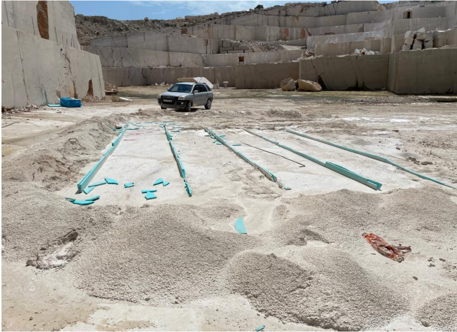
Slika 4-3. Ubacivanje stiradura zbog zaštite rezova
