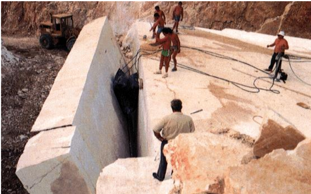
Slika 2-14. Obaranje blokova pomoću zračnih jastuka u kamenolomu Kanfanar, Istra (Dunda i Kujundžić, 2003.)
