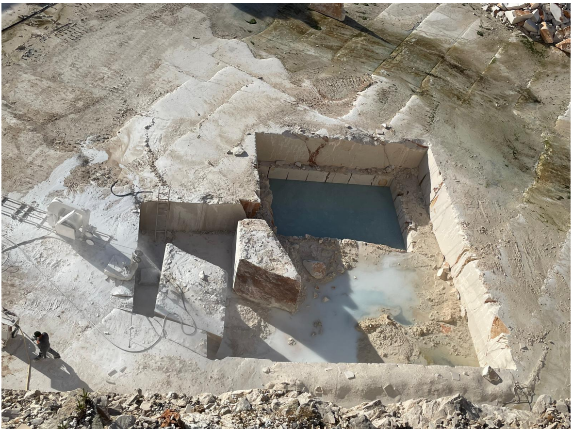
Slika 4-11. Piljenje komercijalnih blokova dijamantnom žičnom pilom
