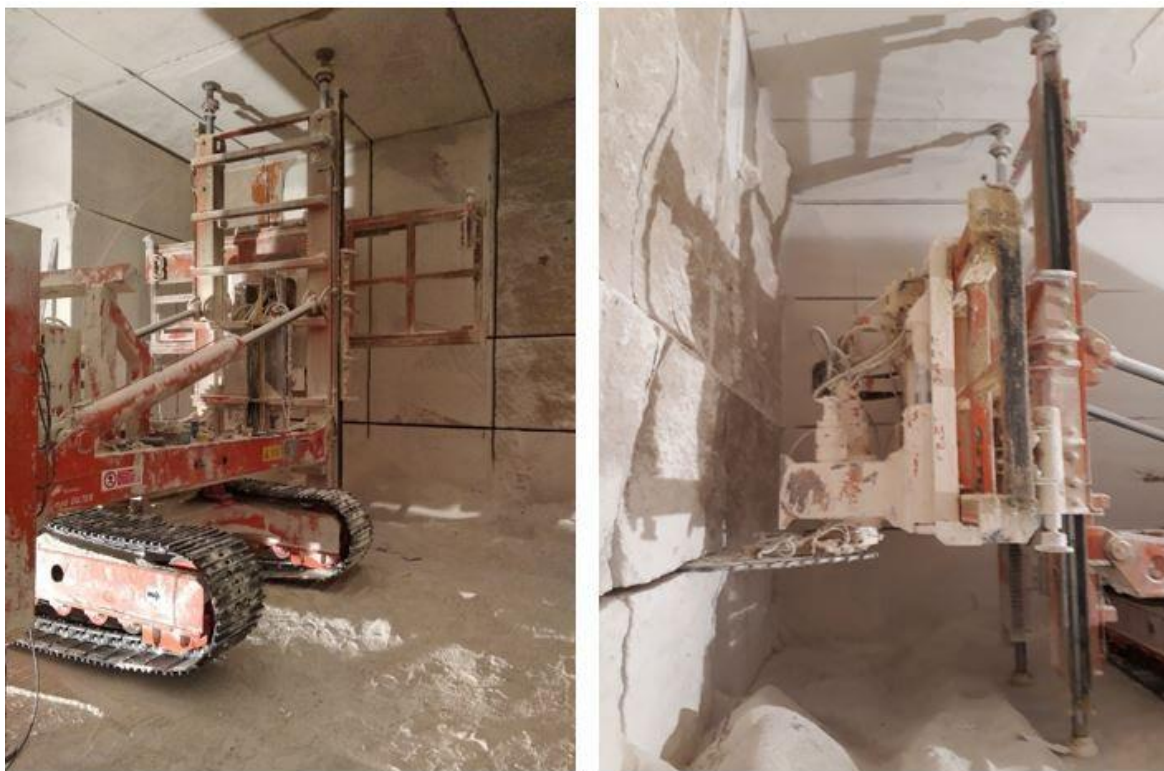
Slika 2-2. Lančana sjekačica u podzemnoj eksploataciji arhitektonsko-građevnog kamena: ( https://www.geotech.hr/en/underground-stone-exploitation/ )
