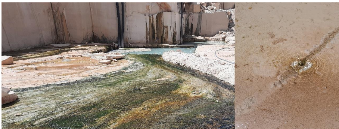
Slika 4-14. Prodiranje vode na etaži sa koje se krenulo otvarati dubinski kop, Punta Barbakan
