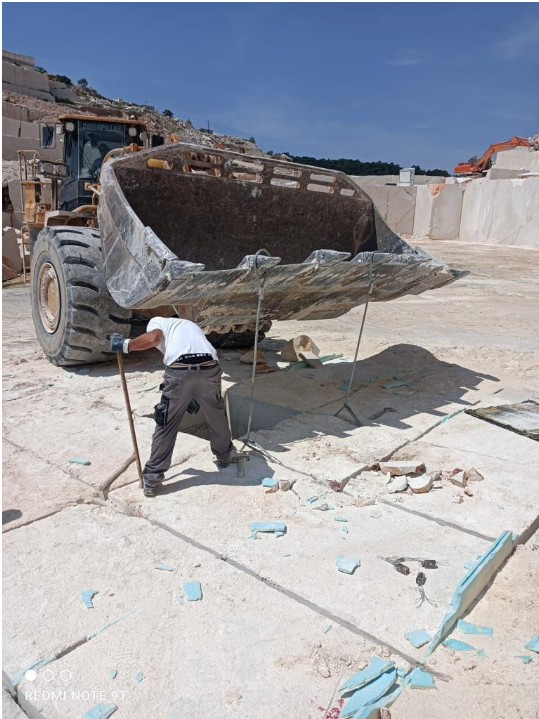
Slika 4-6. Podizanje bloka utovarivačem
