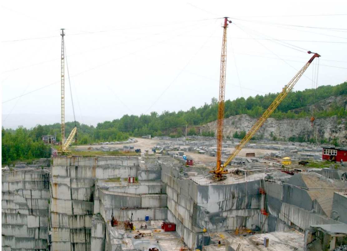
Slika 4-18. Derrick dizalica u kamenolomu (Wikipedia: https://hr.m.wikipedia.org/wiki/Datoteka:Two_Guy_Derricks_at_a_Granite_Quarry.jpg )
