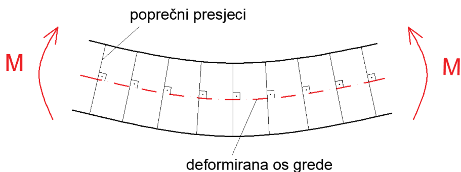
Slika 2-3. Shematski prikaz osi i poprečnih presjeka grede opterećene na savijanje
