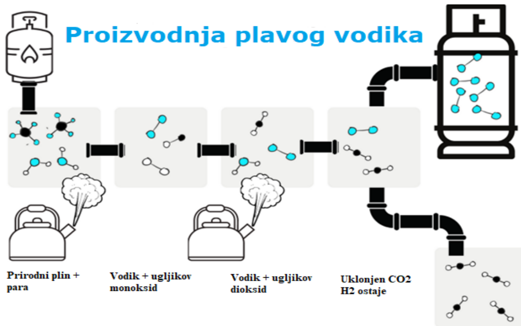
Slika 2-4. Proizvodnja plavog vodika iz prirodnog plina (Medium, 2021)
