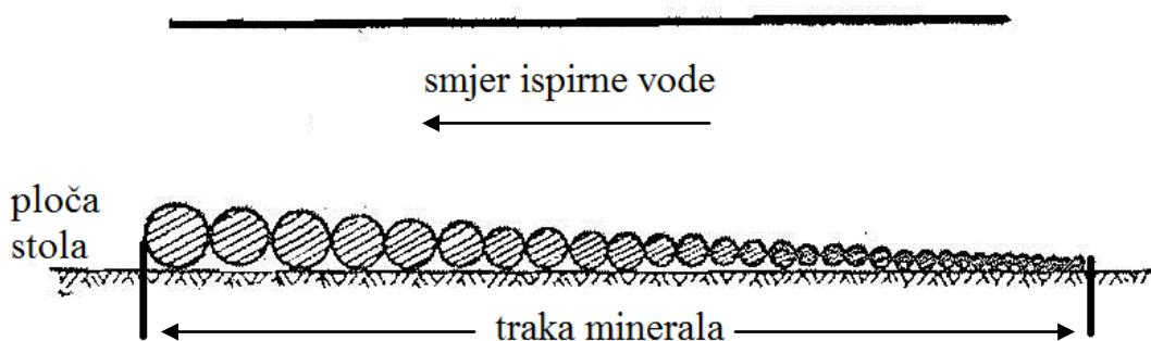
Slika 4-5. Poprečni presjek mineralnih zrna na glatkoj ploči koncentracijskog stola (Lešić i Marković 1968).
