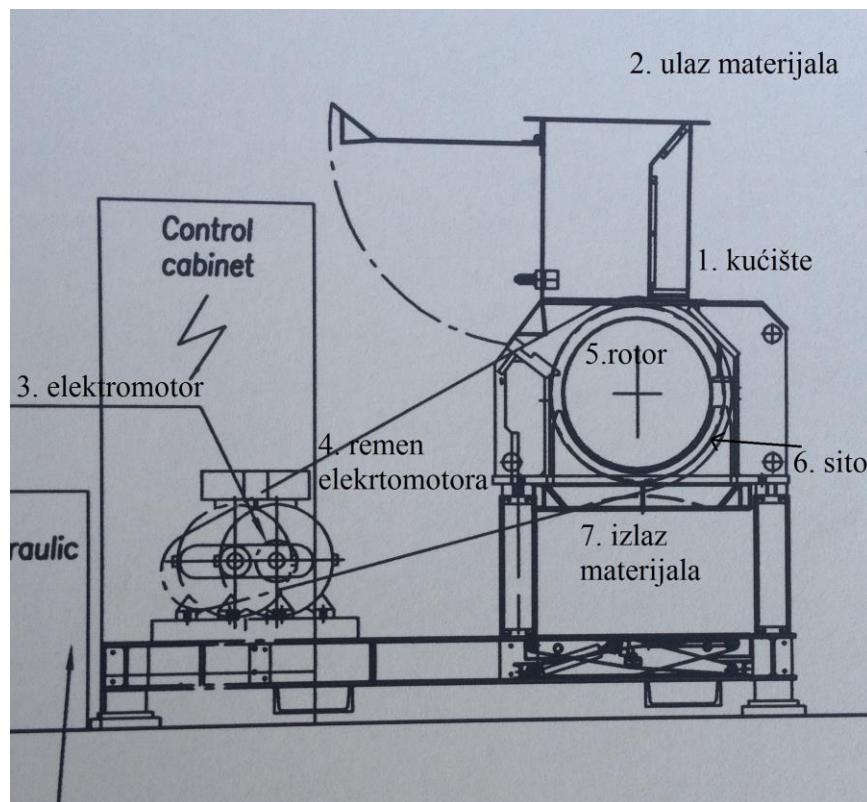
Slika 7-2. Osnovni djelovi granulatora UG 600 (Spectra Media 2015).
